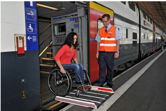
Hilfestellung mit Faltrampe und Personaleinsatz
